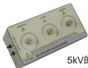
5kV的绝缘测试仪适配器用在高阻绝缘测试仪上
